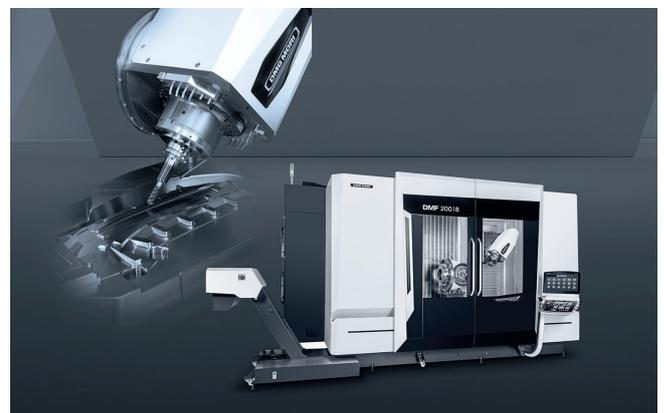
2 In der fünfachsiglen Bearbeitung von Werkstücken bis 2300 mm Länge will das Fahrständer-BAZ DMF 20018 eine Erfolgsgeschichte fortschreiben; es bietet eine Schnittstelle für die automatisierte Fertigung, etwa für das PH-Cell-Paletten-Handling © DMG Mori
